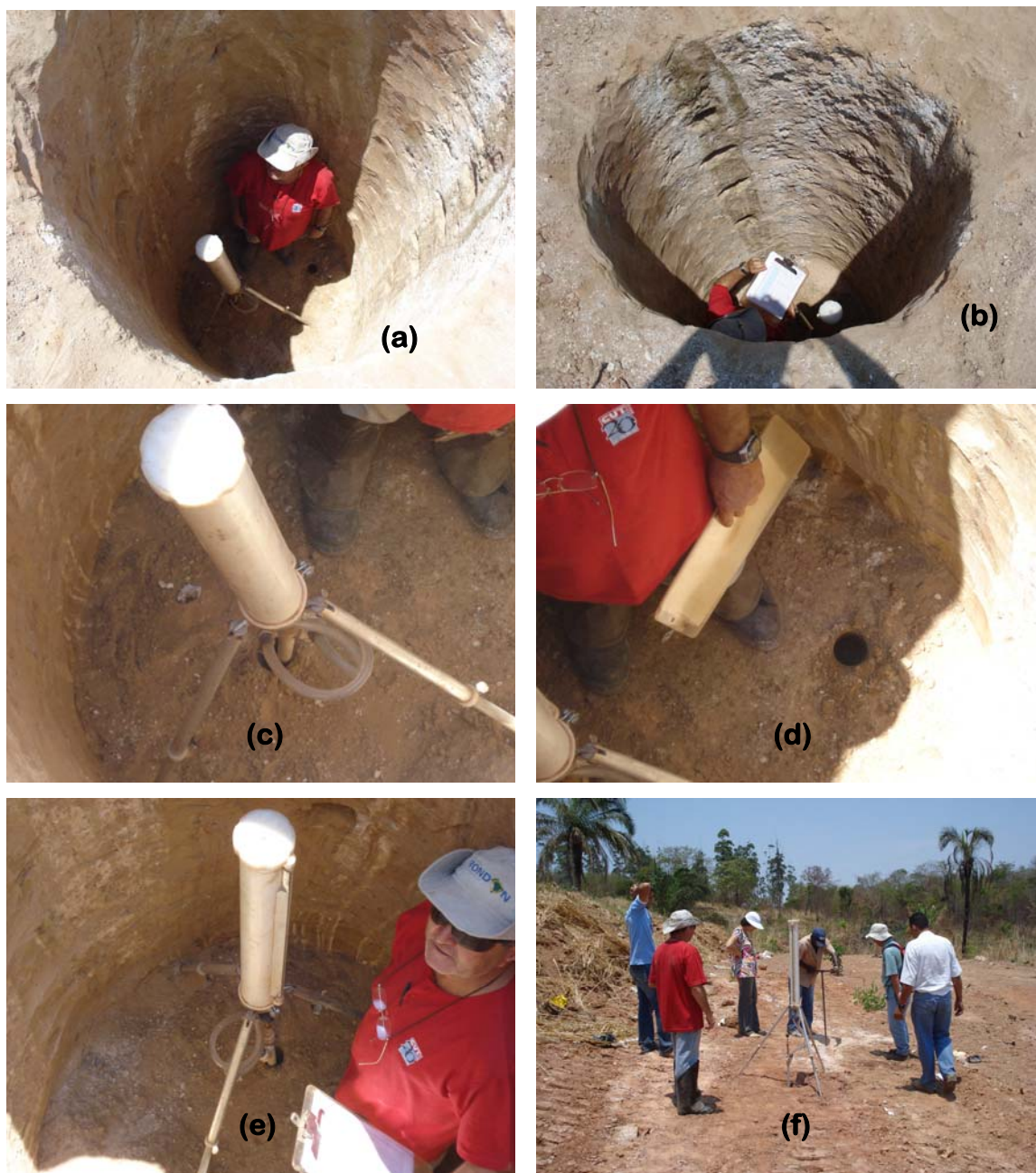
Figura 6.7 – Ensaio de permeabilidade no poço P1 (a, b, c, d, e) e superfície S2 (f), na atual área do lixão do município de Rio Quente/GO, em 15/10/2007.
