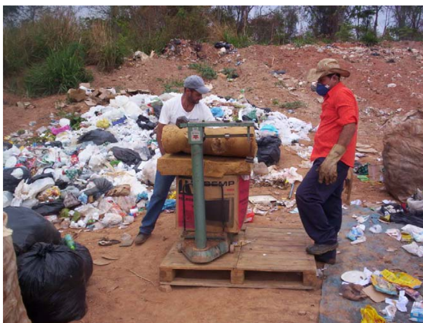
Figura 3.5 – Pesagem dos RSU na atual área do lixão (10/2007).
